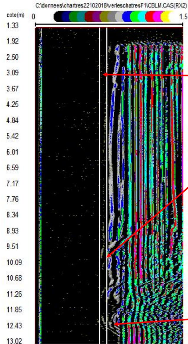
La mesure CBL est basée sur la résonance mécanique du tubage sous l'effet d'une excitation acoustique.
