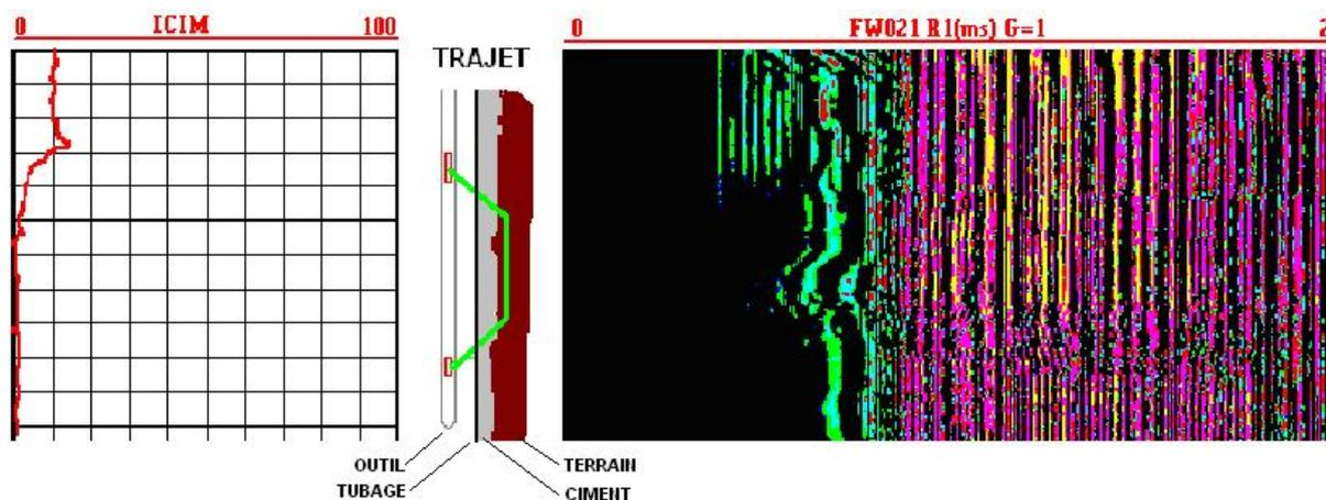
En pratique, pour qualifier la cimentation, on calcule l'énergie de l'onde reçue dans une fenêtre de temps centrée sur l'arrivée première correspondant à l'onde acoustique réfractée par le tubage. On en déduit une courbe de non cimentation ; plus cette énergie est grande moins le couplage forage/terrain est bon, ce qui met en évidence un manque de ciment ou une mauvaise adhérence du ciment avec le tubage ou avec le terrain.
