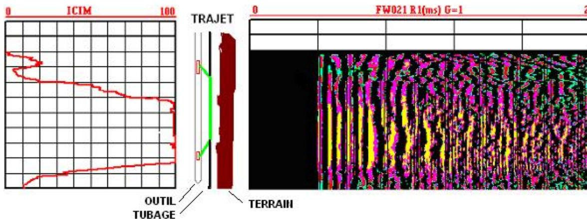
Fig 2 : Bonne et très bonne cimentation, le tubage est même totalement invisible. L'onde acoustique passe à travers le tubage et transite par le terrain. Les temps d'arrivée sont beaucoup plus longs.
